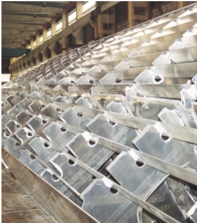
CHARPENTE D'UN MONOCOQUE
